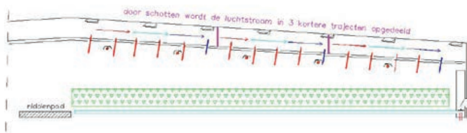
Figuur 5.5.1. Onderbreking van de luchtstroom boven het scherm met schotten breekt de luchtstroom op in 3 kleinere luchtstromen met als resultaat het terugbrengen van de horizontale temperatuurverschillen tussen het gewas tot een derde.
