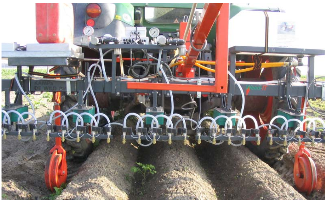
Figuur 6. Weed-IT spuitsysteem voor variabele dosering van gewasbeschermingsmiddelen (variabel spuitvolume door Pulse Width Modulation).
