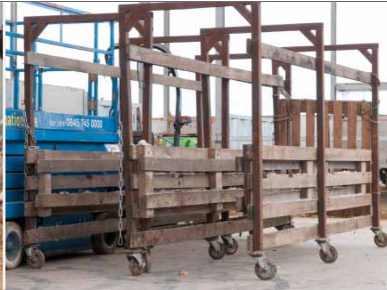
Eigengebouwd vangstelsysteem voor de wekelijkse verzorging van vee
