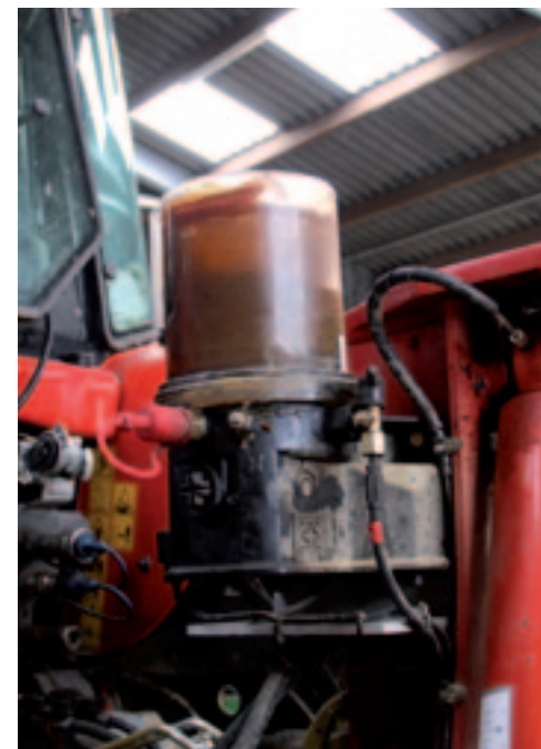
▲ Een smeersysteem is een prijzige optie. Maar met vijftig smeernippels wel handig.
