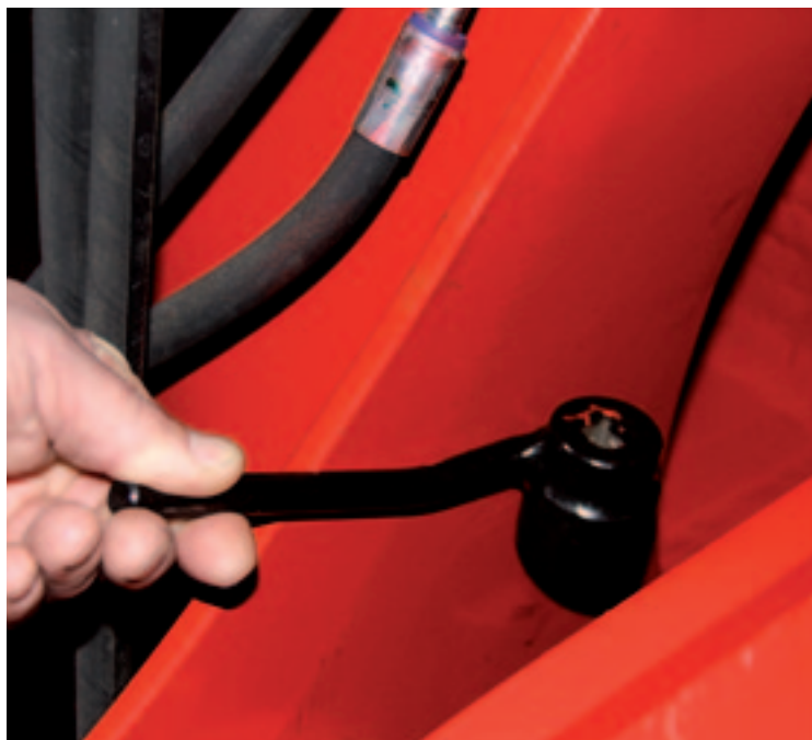
▲ Deze simpele dopsleutel is tevens de aanslag voor de ploegkop. Versteek hem en de ploeg wentelt iets verder en je kunt de eindvoor ondiep ploegen.
