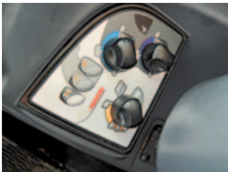
▲ Met een draaiknop kies je tussen manueel schakelen en de vier automaatstanden.
