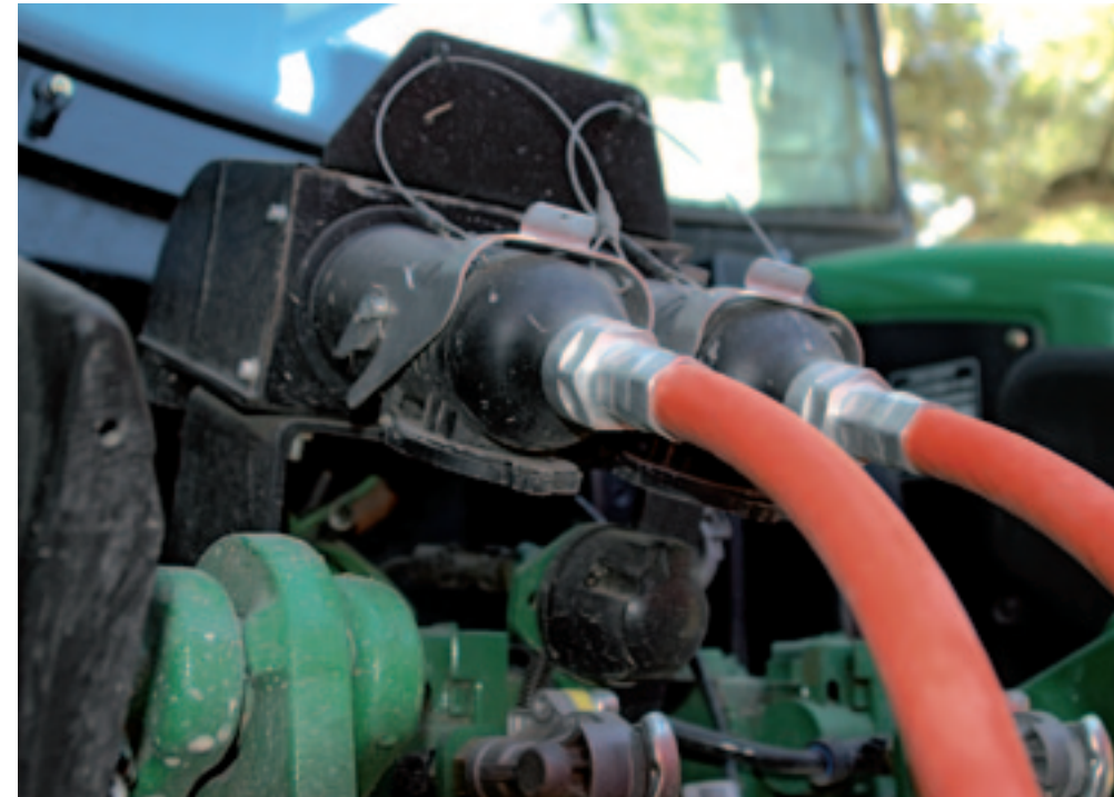
John Deere is met de 7530 E en nu met de 6210 RE voorloper op het gebied van elektrisch overbrengen van energie tussen trekker en werktuig. De generator op de 6210 gaat tot een vermogen van 20 kW.
