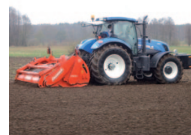
▲ De rijnsnelheid van moderne roterende spitmachines is drie tot vijf keer zo hoog als van de eerste generatie spitmachines.
