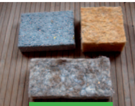
Drie soorten isolatiematerialen Isolatiemateriaal uit papiervezel (grijs), hennep (oker) en vlasvezel (lichtbruin). Foto: GR
