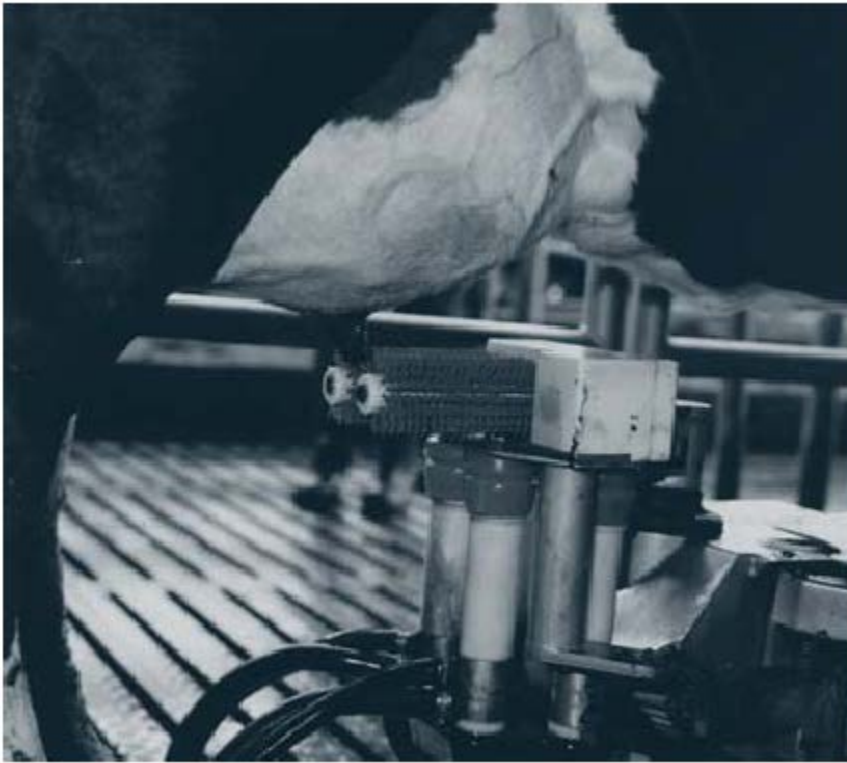
Speenreiniging bij automatisch melken met borstels.
