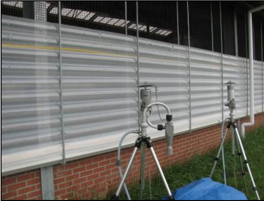
Twee cyclonen (PM10 en PM2,5) voor de bepaling van fijn stof in de ingaande lucht
