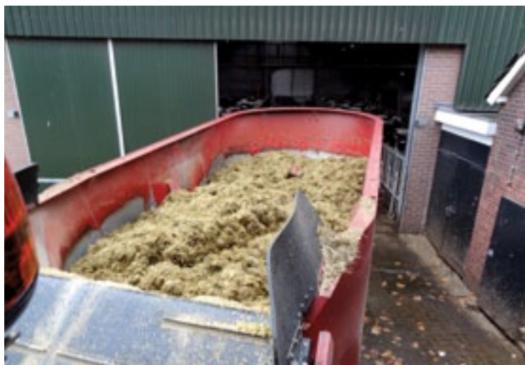
Doordat de cabine omhoog schuift is er een goed zicht in de mengkuip.
