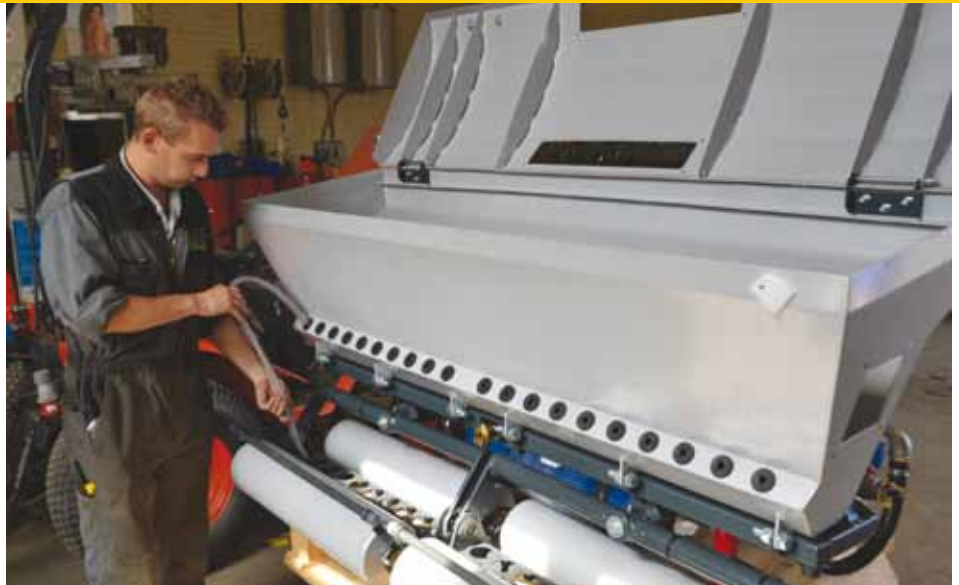
Aanbrengen van de slangen waardoor het water-/zandmengsel onder hoge druk (280 bar) naar de injectors wordt geperst.
