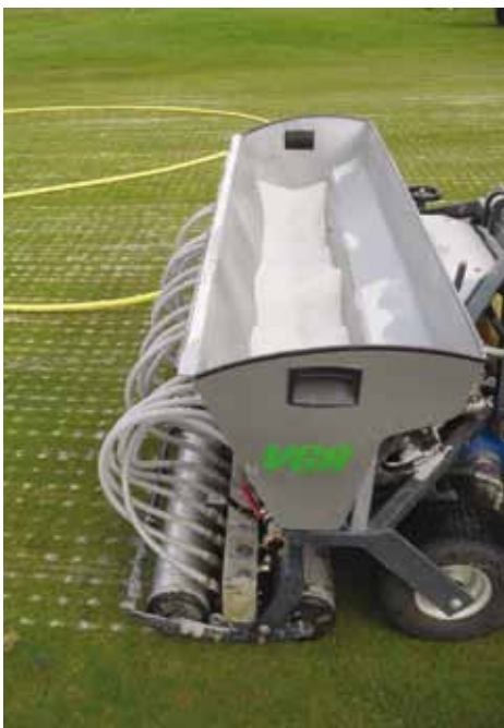
De Topchanger is instelbaar op een niveau tot 5 cm, van 5-10 cm en van 10-20 cm.
