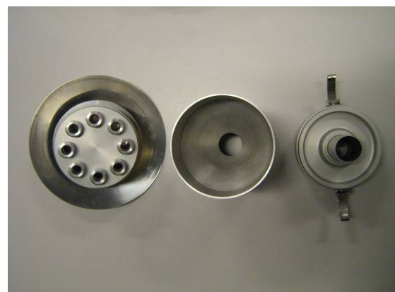
Figuur B1 Links de complete meetset met twee verschillende cyclonen (langwerpig is voor PM10) en de filterhouder en rechts de binnenkant van de luchtinlaat deze is voor beide stoffracties gelijk
