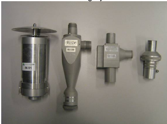
Figuur B1 Links de complete meetset met twee verschillende cyclonen (langwerpig is voor PM10) en de filterhouder en rechts de binnenkant van de luchtinlaat deze is voor beide stoffracties gelijk
