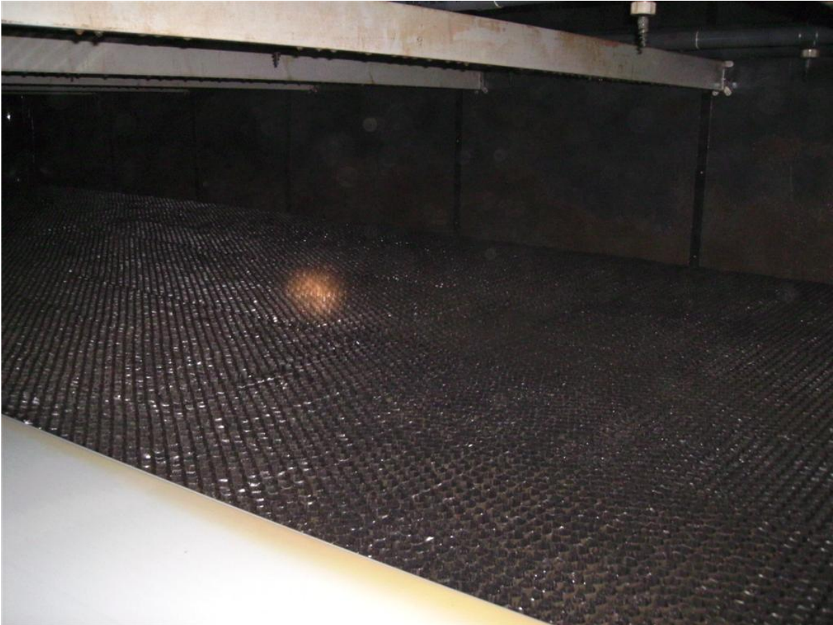
Figuur 2 Bovenaanzicht van het pakkingsmateriaal (sproeiers zijn uitgeschakeld t.b.v. de foto) van de experimentele biologische luchtwasser met denitrificatiesysteem.
