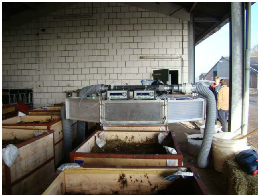
Foto 3 Meetbox opstelling geplaatst op één van de kisten met een compostvariant
