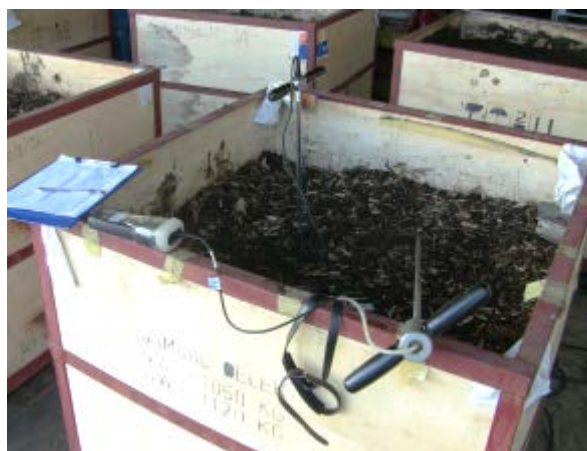
Foto 2 Temperatuursonde (linksboven in reactor), uitleesunit (midden links op rand reactor) en bodemzuurstofsonde (rechtsonder liggend op de rand van een kist)
