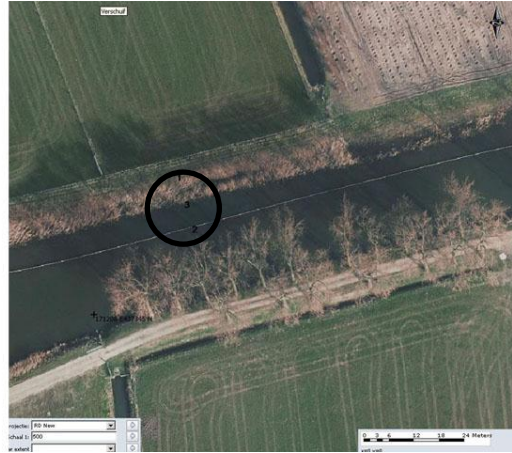
Figuur 9 Homogene oever met beschoeiing. Het lengteprofiel is recht en de beschoeiing op beide foto's duidelijk te zien.
