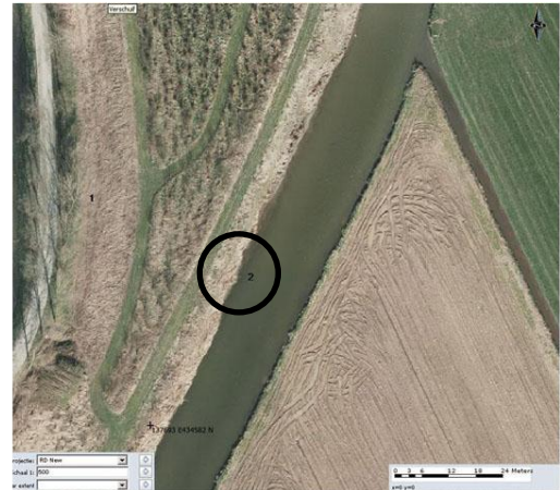
Figuur 8 Homogene flauwe oever. Het lengte profiel is recht, het oevertalud flauw aflopend.
