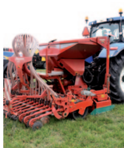
▲ Bij de I-Drill Pro is de zaadtank groter. De verdeelkop en slangen bevinden zich namelijk geheel buiten de machine. Daarom zit het bordes hier ook aan de zijkant.
