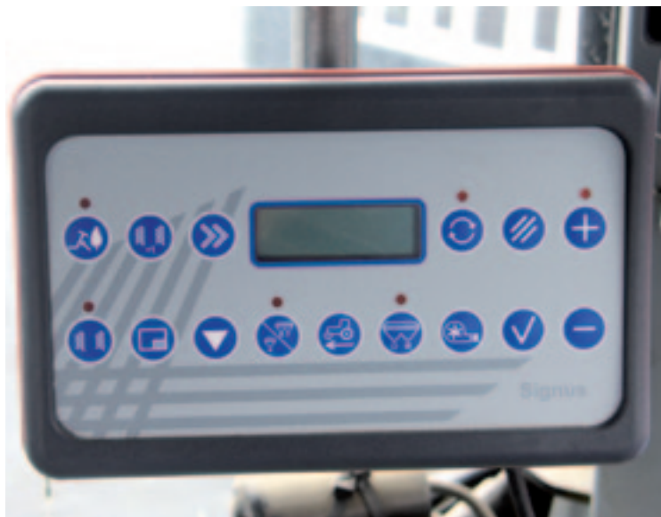
▲ De Signus-computer is de meest luxe niet-isobus-terminal. Hiermee kun je onder andere rijpaden aanleggen en de machine elektrisch afdraaien.
