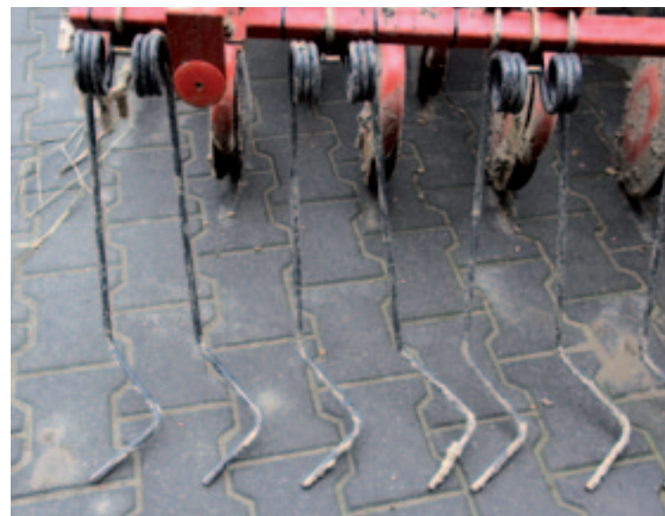
▲ De 10mm S-tand na-eg wordt vooral op kleigrond gekozen voor een goede bedekking van het zaad. De hoek is handmatig in te stellen.
