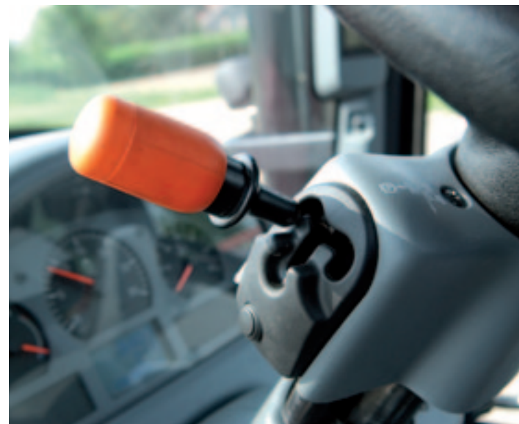
▲ Zodra je de omkeerschakeling uit de P-stand haalt, stijgt het toerental van 650 naar 850 toeren per minuut. Dit om bij het wegrijden over voldoende koppel te beschikken.
