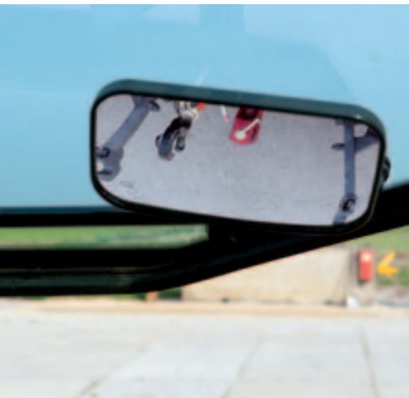
▲ Deze spiegel vereenvoudigt het aankoppelen.
