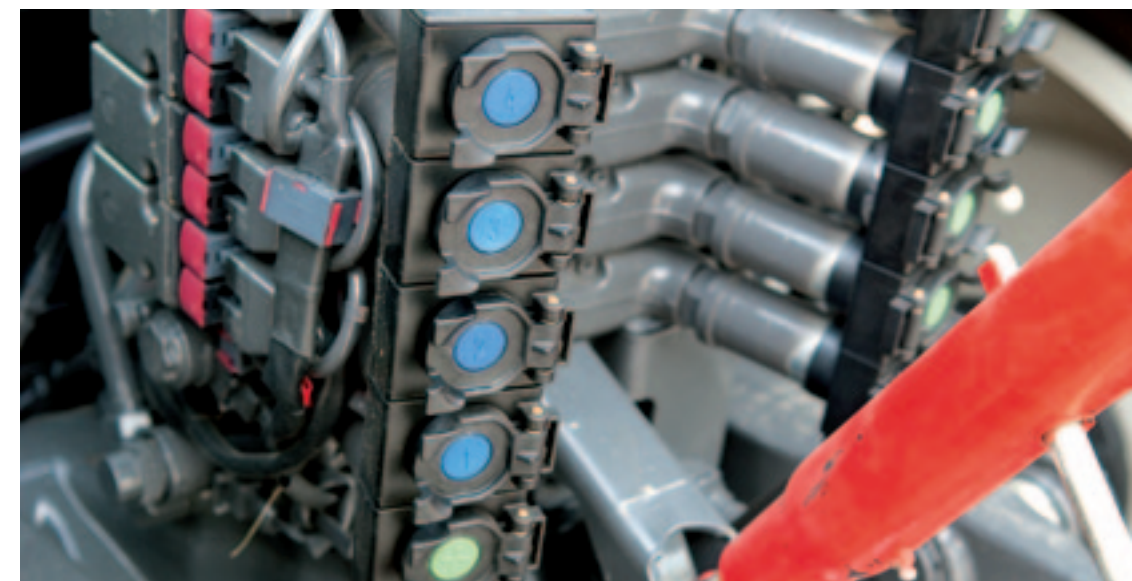
▲ De kleurcodering van de hydraulische ventielen is niet meteen duidelijk.
