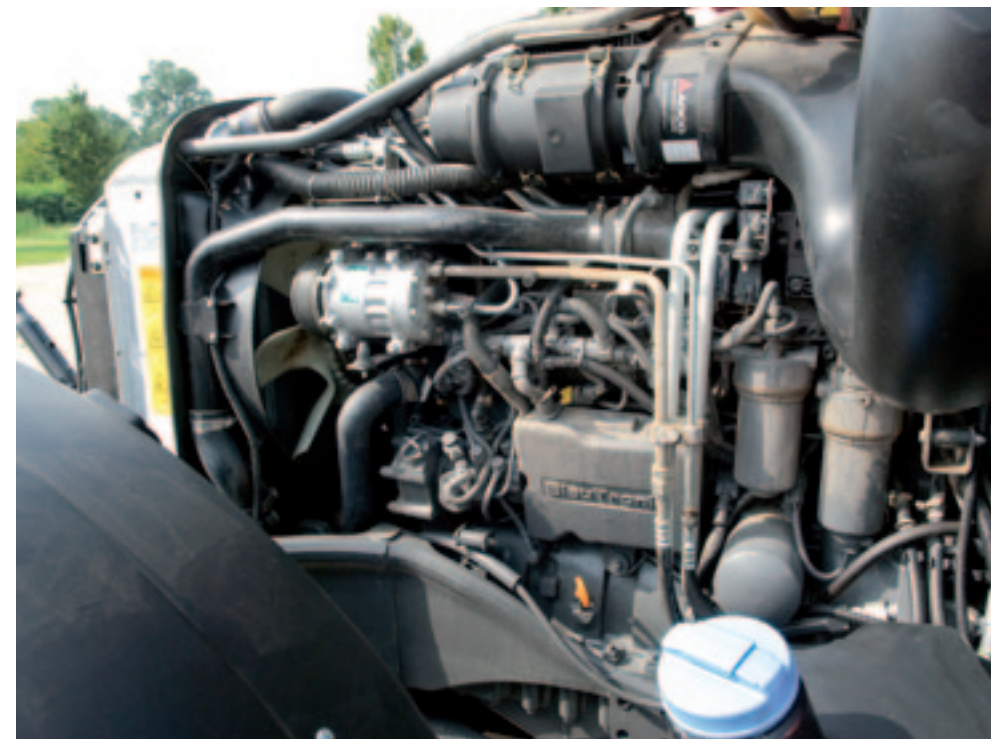
▲ Voor onderhoudswerkzaamheden kan de motorkap helemaal omhoog.
