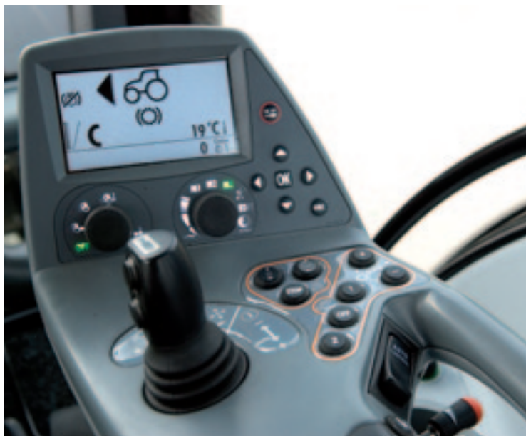
▲ De kleine joystick is praktisch. Je kunt eenvoudig kiezen welke functies je ermee wilt bedienen: frontthef en één dubbelwerkend ventiel of één ventiel voor en één achter of allebei achter.
