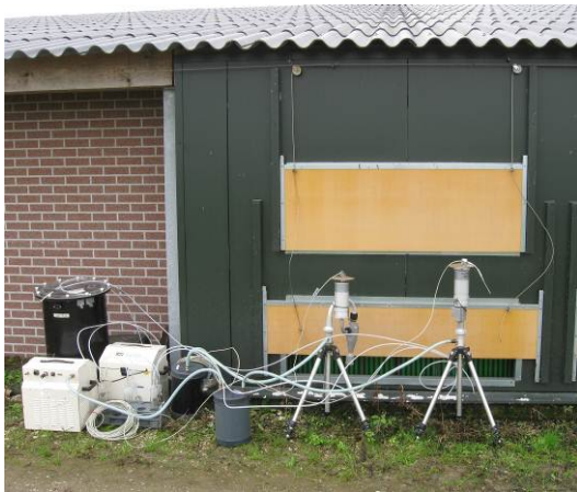
Meetapparatuur luchtinlaat buitenzijde stal
