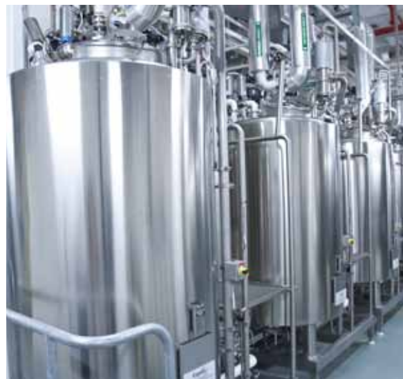
Moderne vaccinproductie waarbij influenzavirus gekweekt wordt in celkweken in fermentoren. (©Sanofi Pasteur)
