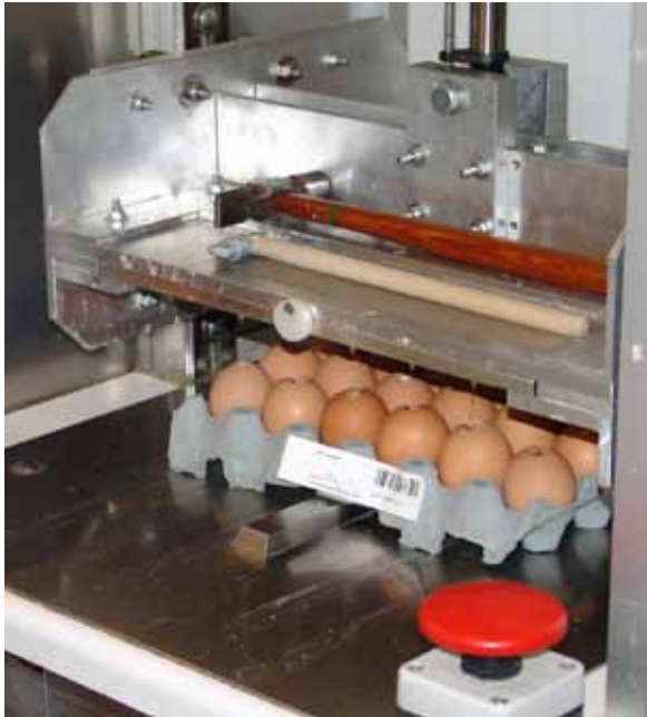
Vogelgriep kan opgespoord worden door antilichamen tegen het virus in de dooier te detecteren. De kippen hoeven dan niet meer handmatig te worden bemonsterd. Om dit grootschalig te kunnen uitvoeren is deze robot ontwikkeld. Foto: Armin Elbers (CVI)
