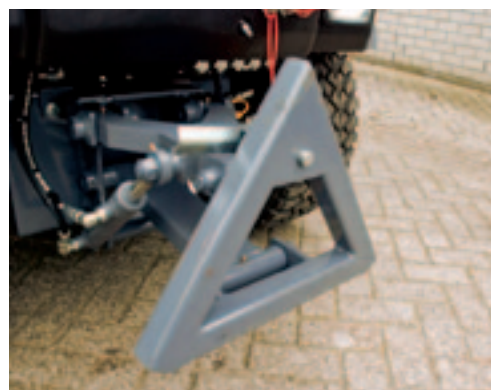
Met het snelwisselsysteem lukt aankoppelen en vergrendelen zonder uit te stappen.
