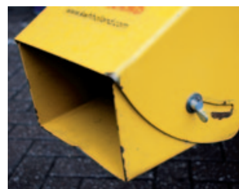
De klep op de blaasmond is verstelbaar om de luchtstroom te sturen.
