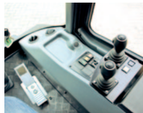
De bediening gaat vanuit de cabine met subtiele joysticks.
