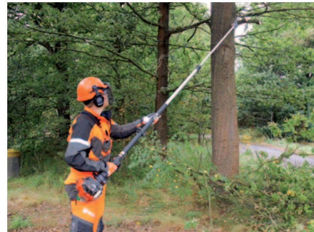
Een goede werktechniek is bij de stokzaag van groot belang. Behalve schade aan de zaag voorkomt een goede werktechniek dat je last krijgt van rug, schouders of armen.
