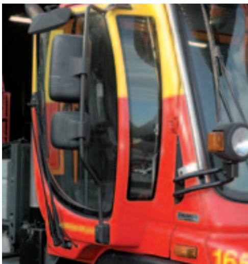
Speciaal voor bermenwerk is op een Unimog een uitgebreide deur leverbaar voor extra zicht opzij.
