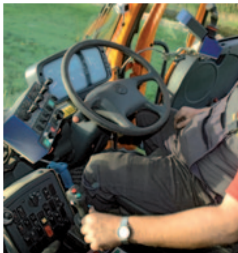
De stuurkolom inclusief pedalen kun je bij het UGN-type van Unimog heel snel van links naar rechts verschuiven.
