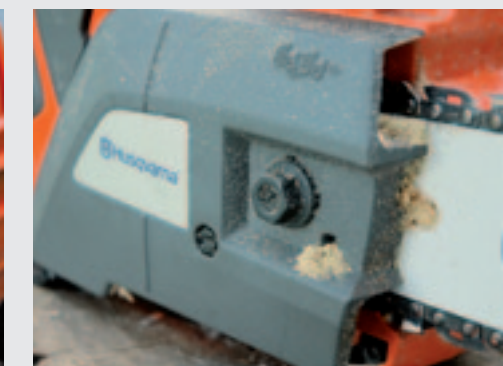
Het spannen van de ketting is via het 'lossen' van de grote bout en het draaien van de stelschroef makkelijk te doen.
