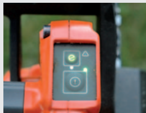
Het knopje van de startbeveiliging met daarboven het e-knopje om de maximale kettingsnelheid te reduceren.
