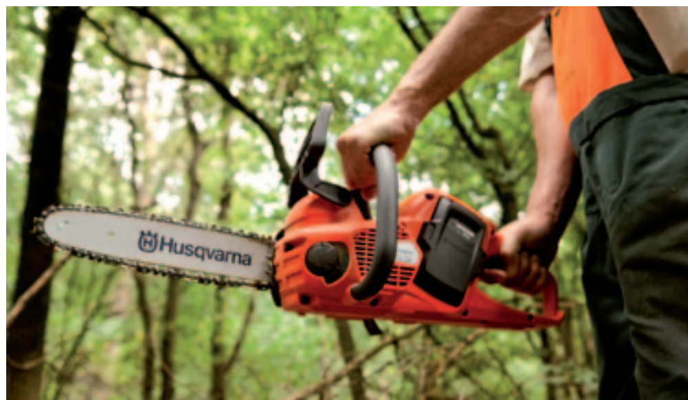
De 536Li is een 'gewone' kettingzaag, maar dan met een accu als krachtbron in plaats van een benzinemotor. De zaag ligt plezierig in de hand. Als de gebruiker te veel hevelt, stopt de ketting.
