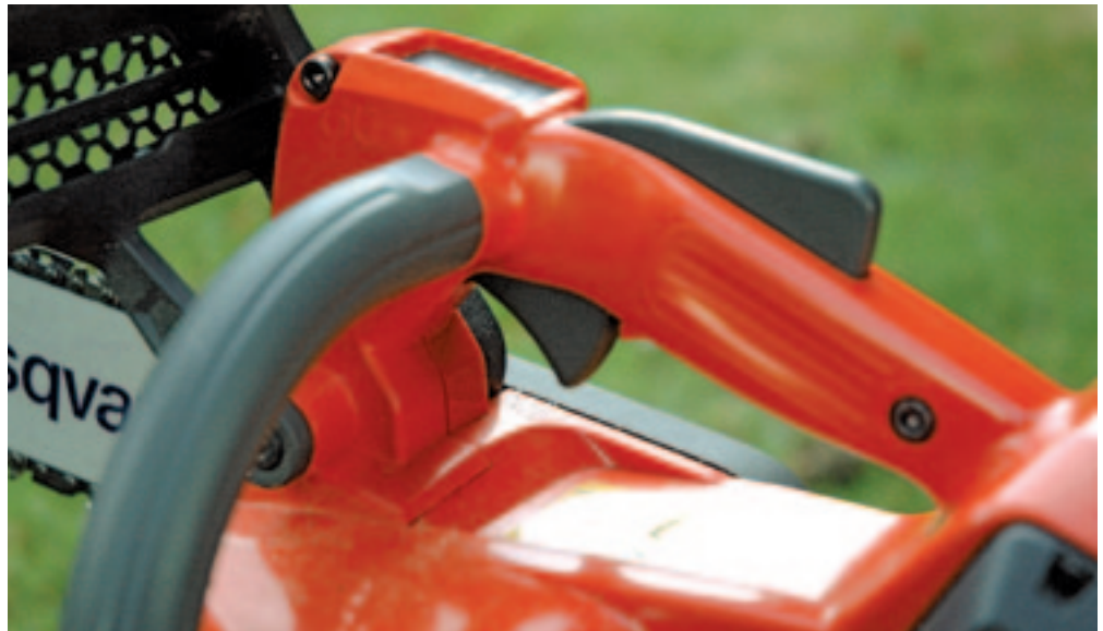
Bij de T536Li als tophendelvariant kan de rechterhand net niet ver genoeg naar achteren. Bij langdurig gebruik levert dat een vermoeide rechter wijsvinger op en wil je de zaag eigenlijk anders vastpakken.
