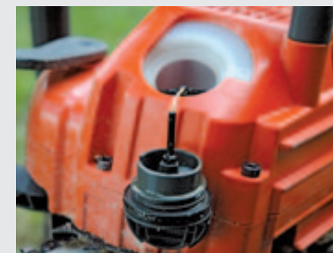
De vuldop is makkelijk te openen en te sluiten en het niveau via het kijkglasje makkelijk te controleren.
