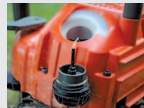
De vuldop is makkelijk te openen en te sluiten en het niveau via het kijkglasje makkelijk te controleren.
