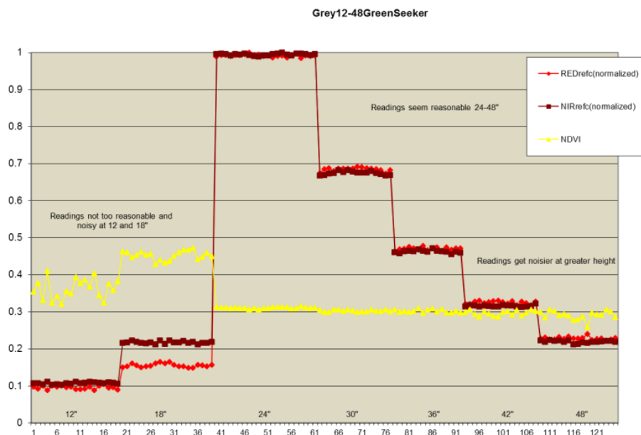
Figuur 9. Reflectie metingen boven een grijs paneel met Greenseeker sensor op verschillende hoogtes (bron: Del Nantt CropScan Corp).
