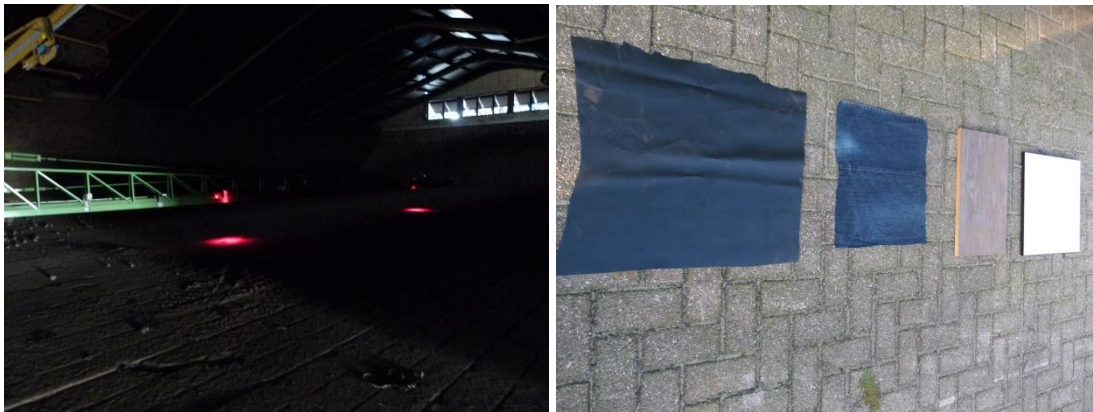
Figuur 1 (links) en 2 (rechts): Opstelling meet experiment met sensoren op spuitboom en verduisterde schuur (de luiken zijn voor het experiment nog gesloten) en toegepaste referentie materialen in experiment van links naar rechts: vijverplastic, spijkerstof, licht bruin geverfde plaat en witte referentie plaat.
