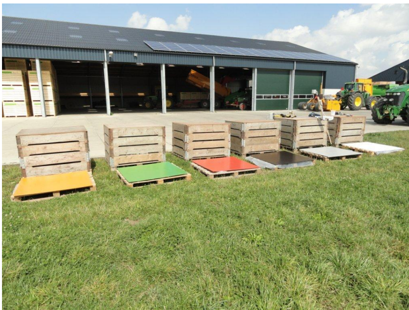
Afbeelding 1. Schets van opstelling t.b.v. kalibratie reflectie sensoren.
