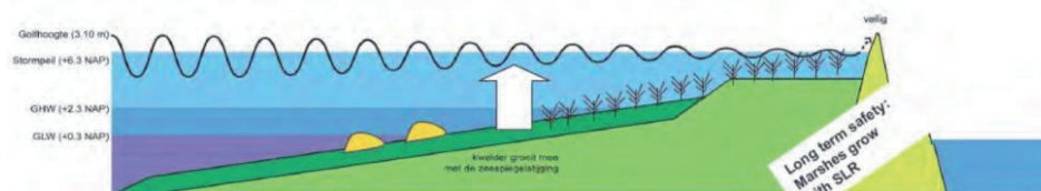
Afbeelding 15 - Principe kwelderwal (Van Loon-Steensma et al., 2012a)
