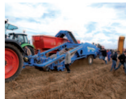
▲ De Britse machinefabrikant Standen Pearson demonstreerde in Frankrijk de getrokken tweerijige wagenrooier T2. De machine beschikt over een eigen hydraulisch systeem dat wordt aangedreven met de aftakas. Opvallend is dat de machine in plaats van diabolrollen is uitgerust met slappe rubberbanden voor de instelling van de rooidiepte. Na de graaf- en de vrij steile opvoerketting komen de aardappelen terecht op de Omega-separator, een bewezen techniek met een set grote rubberen rollen met een spoed die worden afgewisseld met kleine niet aangedreven rubberen rollen. Om ook in natte percelen goed vooruit te kunnen, is de machine uitgerust met hydraulisch aangedreven wielen.
