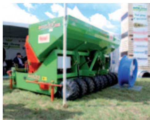
▲ Frezenfabrikant Baselier uit Steenberghe heeft een poot-freescombinatie gebouwd. De fabrikant heeft daarvoor een Wifo-pootmachine – net als Baselier een bedrijf dat onderdeel uitmaakt van de APH-holding – achterstevoren bovenop een volveldsfrees gebouwd. De combinatie die bedoeld is voor gebruik op lichte grond spaart de teler een werkgang en dus brandstof uit. De machine freest eerst de grond over de volle breedte. Boven de frees zit de 2 ton grote voorraadbak. De hydraulisch aangedreven pootelementen hebben achterstevoren een plek gekregen achter de frees. Na de schijven volgt nog een anaardkap die de definitieve ruggen vormt. Deze kap ontbrak overigens op de getoonde machine.
