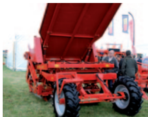
▲ De Duitse machinefabrikant Grimme liet de GB 330 zien: een getrokken drierijige snarenbedpootmachine die de aardappelen niet in ruggen maar in een bed poot. Op het bed van 1,80 meter breed staan de rijen 42 cm uit elkaar. Groot voordeel van de beddenplanter is dat je per vierkante meter meer poters kunt planten dan op twee rijen. Daardoor groeien de knollen gelijkmatiger en stijgt de opbrengst in de goed verkoopbare pootgoedmaten, aldus Grimme. Overigens kan het middelste pootelement ook worden uitgeschakeld. Probleem bij de beddenteelt is altijd om voldoende grond op de poters te krijgen, erkent Grimme. Maar de fabrikant claimt dat dit probleem is overwonnen met het zogeheten DLG Board.
