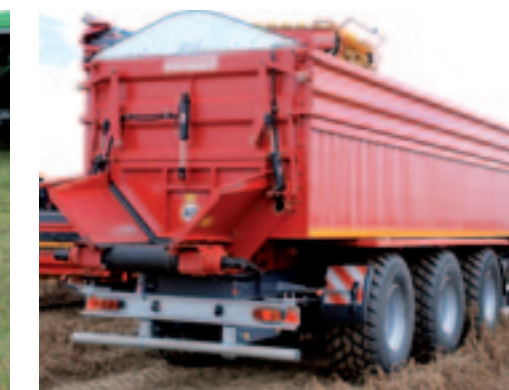
▲ Grimme reed een deel van de oogst naar de inschuurlijnen met een imposante drieassige aardappelwagen, waarvan de voorste en achterste as meestuurt. De wagen kan niet kiepen, maar is voorzien van een losband. Bij het lossen gaat er aan de achterzijde een klep open en kan de chauffeur de snelheid van de losband traploos instellen. Om de valhoogte tussen de transporteur van de rooier en de bodem van de wagen tot een minimum te beperken, kan een deel van het zijschot hydraulisch naar beneden worden geklapt. Als de wagen vol is, kan de chauffeur vanaf de trekker hydraulisch een afdekzeil over de wagen trekken. Verder is de wagen voorzien van pneumatische remmen en vering. LM
