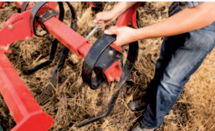
▲ De buitenste egalisatietand moet in het veld naar buiten worden gesteld. Dat kan in een aantal stappen. Doe je dat niet, dan krijg je bij de aansluiting tussen twee werkgangen een rug.
