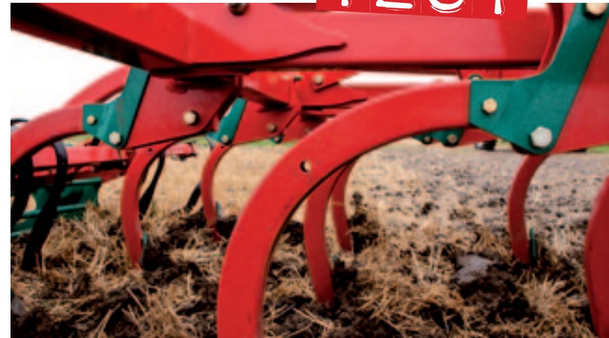
▲ Door een speciaal hardingsproces kunnen de holle tanden van de CLC Pro Classic grote krachten aan. Zijdelings kunnen de tanden 14 cm uitwijken, naar achteren kunnen de tanden 10 cm buigen.
