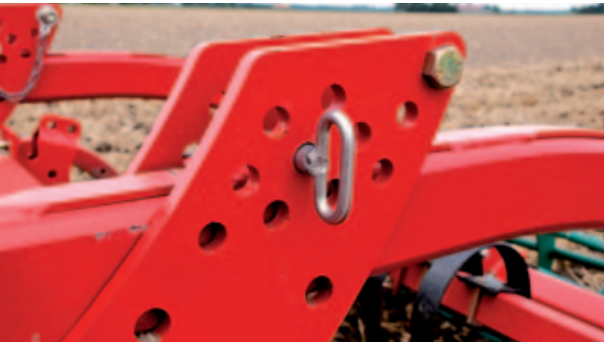
▲ De werkdiepte van de machine is eenvoudig en heel precies in te stellen door een pen in een ander gat te steken.
