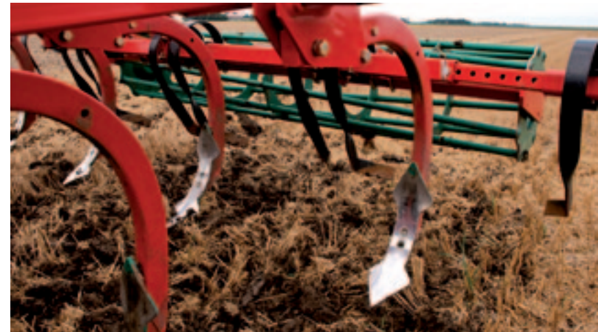
▲ Standaard is de CLC Pro Classic voorzien van omkeerbare beitels. Maar wie de grond over de volle werkbreedte wil losmaken, kan ook kiezen voor 300 mm brede ganzenvoeten.
