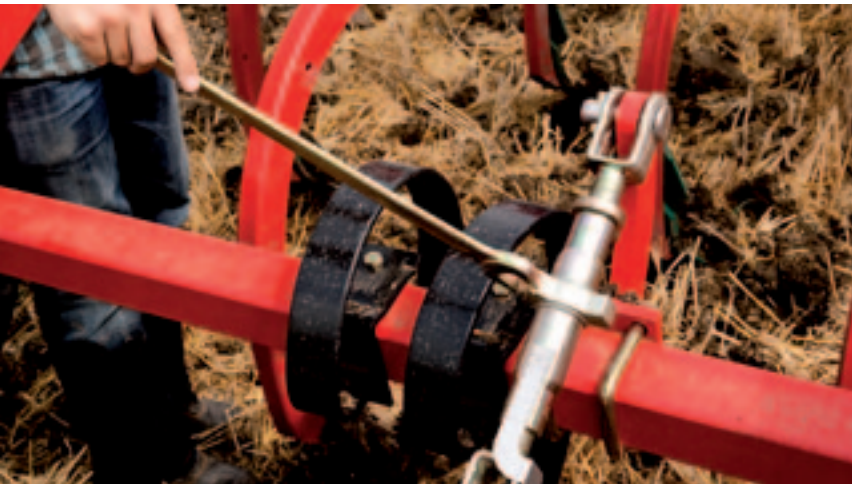
▲ Met een spindel zijn de egalisatietanden achter de cultivatortanden meer of minder slepend af te stellen.
