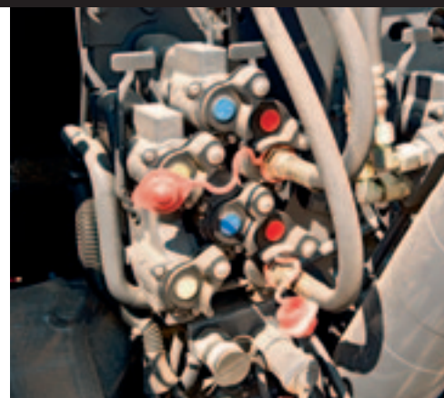
▲ Maximaal zijn vier elektrohydraulische ventielen op de Power-versie leverbaar. Bij de luxere versies zijn dat er zeven.
