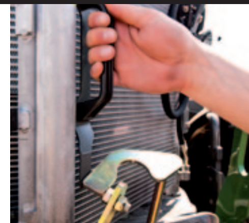
▲ De koelers klappen naar de zijkant open. Detail: een kunststof strip beschermt de koeler tegen beschadiging door de topstanghouder.
