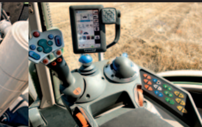
▲ Alle knoppen van de multifunctionele hendel kunnen een andere functie krijgen. In dit geval stel je dat in via de 7 inch-Varioterminal.
