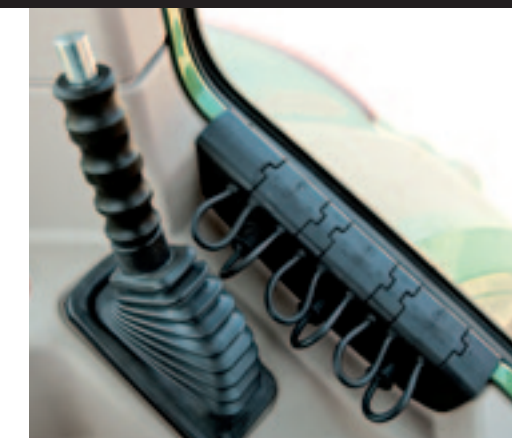
▲ Nog zo'n detail: de doorvoer voor stroomkabels in de achterruit. Door een elementje weg te halen komt er ruimte voor de kabel.
