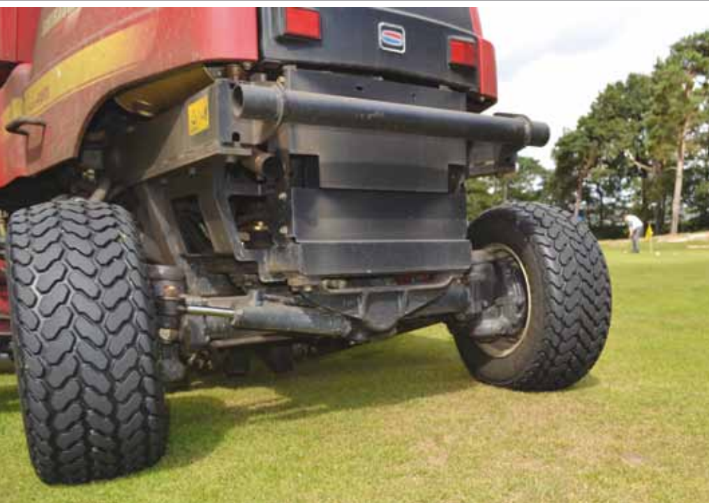
De Shibaura is qua uiterlijk een soort omgekeerd rijdende hydrostatisch aangedreven trekker.
