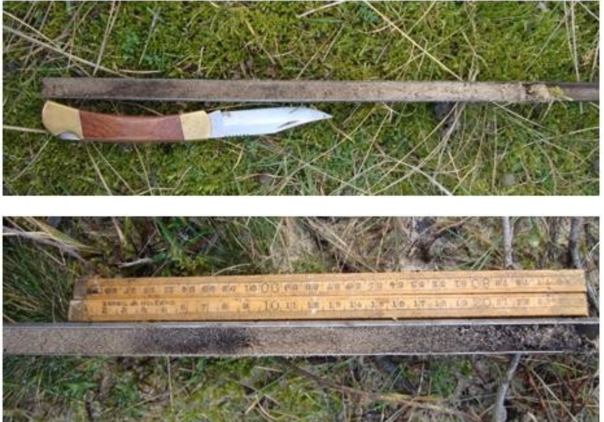
Figuur 3.1 Voorbeeld van boringen, boven met overstuiving, onder zonder.
