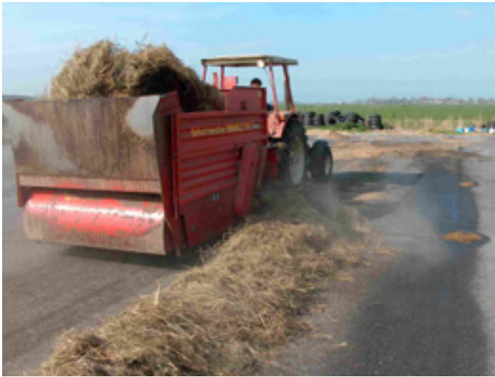
Foto 1: De balen worden in een voermengwagen los gesneden en in een wiers op het erf gelegd.
