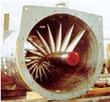
Foto 8: Het inwendige roerwerk van een propstroomvergister.
