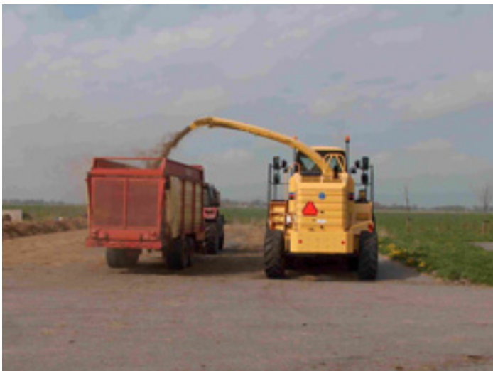
Foto 3: ...en het gras wordt in de opraapwagen geblazen
