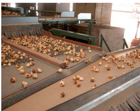
De grootste maten worden het eerst gesorteerd, de overige bollen gaan onder de afvoerband door verder
