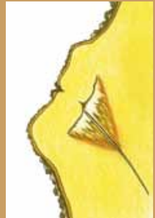
Fase 4, inkapseling van de micro-organismen. Als de rot is ingesloten, is er geen zuurstof meer beschikbaar voor zuurstof-afhankelijke afbraakschimmels.
