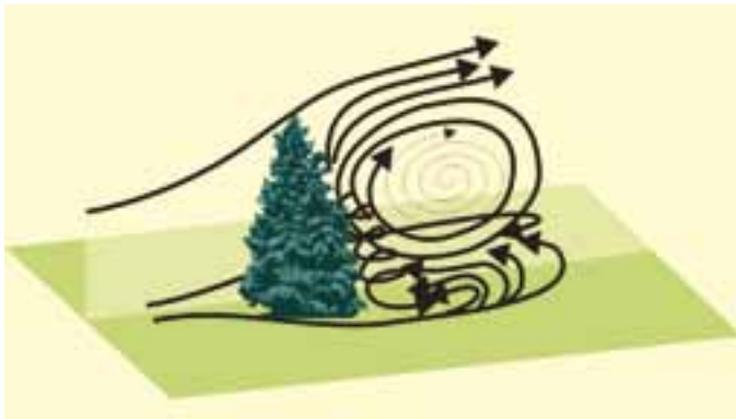
Afbeelding 6 Schematische weergave van de luchtstroming achter een boom. Hier ontstaat een zone met wervelingen en terugstroming. Dit 'Ablösegebiet' is rekenkundig moeilijk te benaderen omdat diverse ruimtelijke effecten kunnen optreden die elkaar beïnvloeden.
