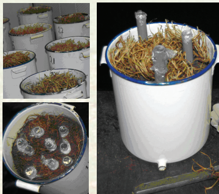
Figuur 1: De incubatie werd uitgevoerd met ongestoorde monsters. Op T=0, 2, 6 en 12 werden 3 steken uit het monster gehaald. De gaten werden opgevuld met plastic buisjes om uitdroging via de gaten te voorkomen.
