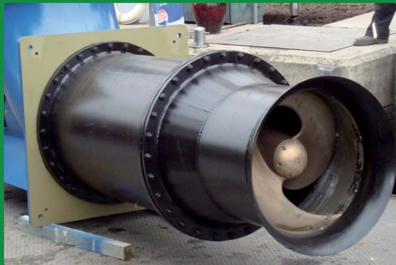
De speciale schoepen in de axiaalpomp voorkomen dat vissen gewond raken.
