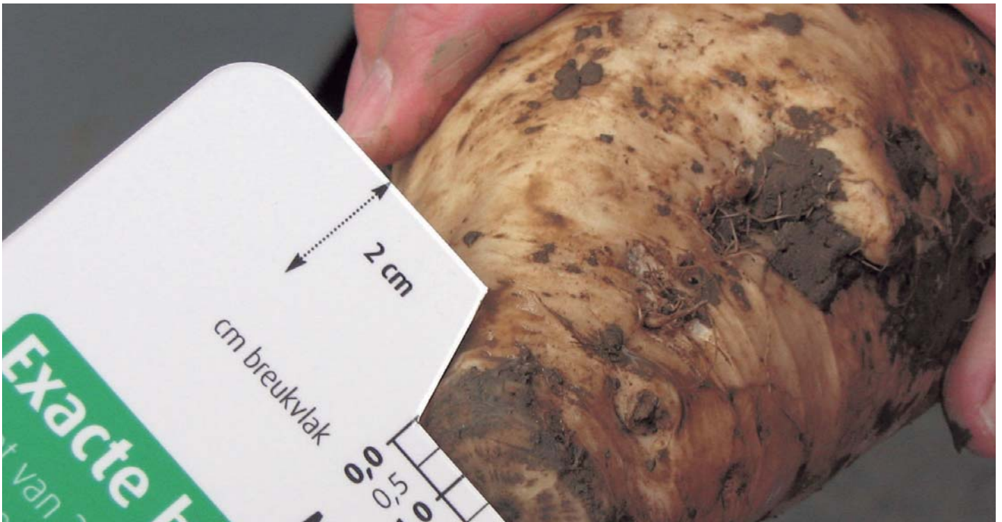
De insparing met aanslag is voor het opmeten van de diameter van de puntbreuk. Meet bij bieten aan de hoop alleen aan breuken ontstaan bij het rooien, niet aan witte verse breukvlakken ontstaan door het storten aan de hoop.
