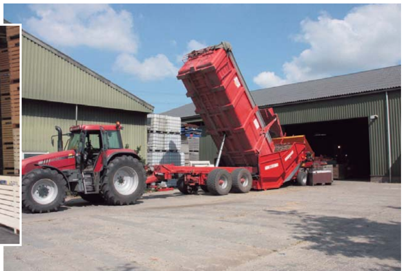
▲ Op het erf van Van Tiggelen worden de aardappels gelost in een nieuwe Grimme RH 24-60 stortbak. Deze werd samen met collega Ad Mouwen uit Wouw gekocht. De stortbak heeft een capaciteit van 19 kuub. Als de kiepkar leeg is, heeft de stortbak nog voorraad voor acht kuubskisten.
