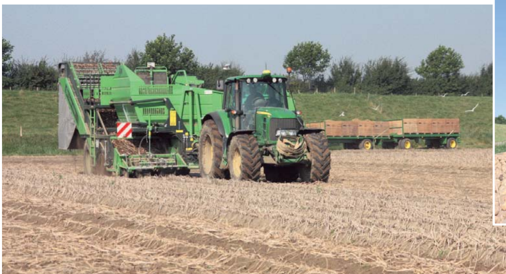
▲ Willem Testers uit Kruisland rooit onder Nieuw-Vossemeer een perceel Vasko's, een vastkokende aardappel die enkel hij teelt. Het perceel is 17 hectare groot. De bunkerrooier, een AVR spirit 8200, kan bijna 8.500 kilo aardappelen per keer meenemen.
