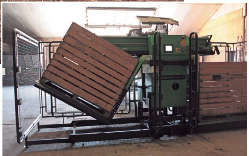
▲ De aardappels gaan via de stortbak en de transportband naar de kistenvuller. Potters heeft een Miedema kistenvuller. Hij bevalt goed. Met name de manier van instorten: doordat de kist schuin wordt afgevuld, beschadigen de aardappelen nauwelijks.
