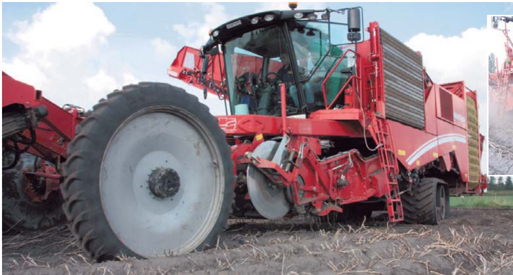
▲ De Grimme Varitron heeft twee smalle grote voorwielen. Daarnaast loopt de machine op rupsbanden. Gewicht: 29 ton.
