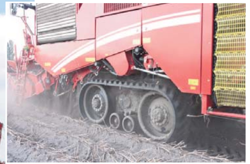
▲ De Grimme Varitron heeft twee smalle grote voorwielen. Daarnaast loopt de machine op rupsbanden. Gewicht: 29 ton.
