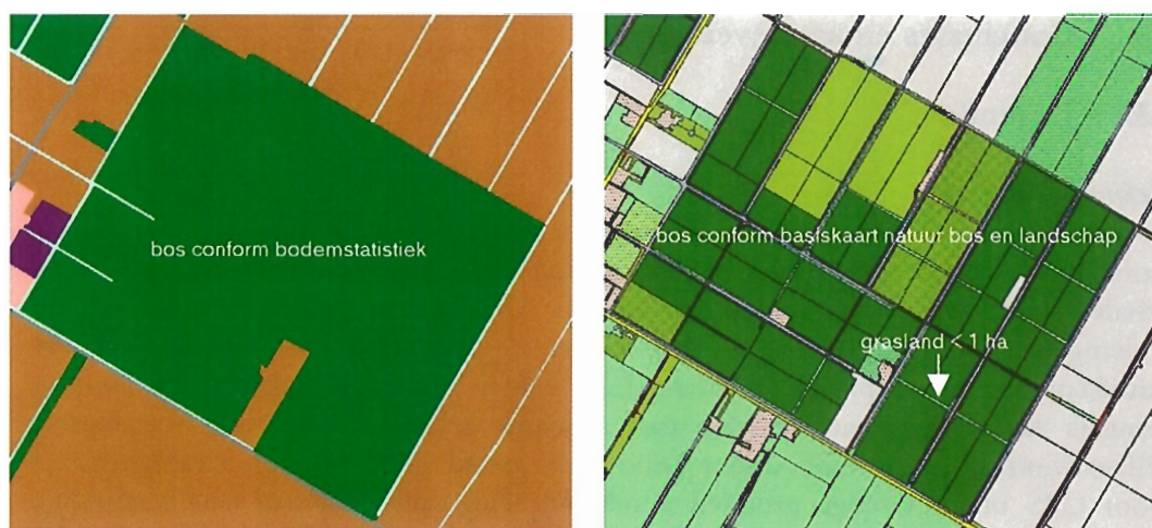
Figuur 5 Verschil in detailniveau van de Bodemstatistiek (TOP10bodem) en de digitale topografische kaart van Nederland (TOP10vector). Hier wordt het probleem geïllustreerd van de toewijzing van graslanden < 1 ha uit de TOP10vector en bossen > 1 ha uit de TOP10bodem aan een van de terreintypen van de BNBL.
