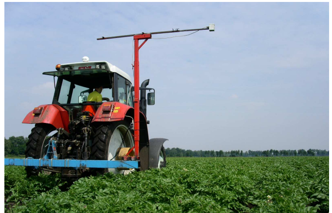
Met de Cropscan en GPS-apparatuur wordt een plaats specifieke bijmestgift in aardappelen bepaald.
