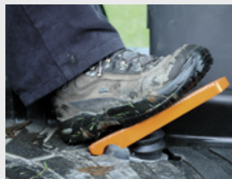
Het gaspedaal is tevens rijpedaal en het regelt elektronisch de juiste mix van zowel de toeren van de motor als de snelheid.
