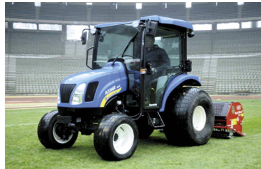
De cabine van de Boomer is voorzien van een ruime hoeveelheid glas, ook aan de voorzijde in het dak. Het zicht (ook op een eventuele voorlader) is daardoor goed. Voor de chauffeur zelf is de leefruimte voldoende; voor een bijrijder is er geen plaats. De geluidsdruk in en om de Boomer is laag.
