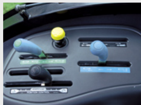
De hendels voor de hydrauliek laten zich makkelijk bedienen en dat geldt ook voor de gele knop die de pto in- of uitschakelt.
