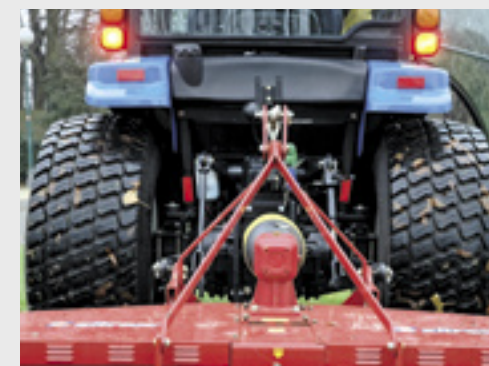
De hef tilt maximaal 1.600 kg en de olieopbrengst is maximaal 36,9 l/min. De dieseltank zit in de achterwand van de cabine.
