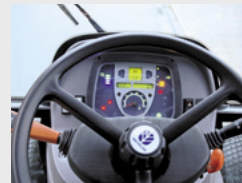
Het instrumentenpaneel is grotendeels digitaal. Links de hendel voor voor- en achteruit; rechts (ook in oranje) het handgas.
