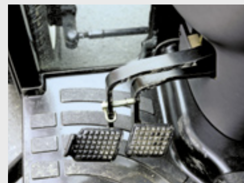
Bijzonder voor een 'verse' chauffeur is dat het rempedaal links zit en daar de plaats inneemt van de koppeling.
