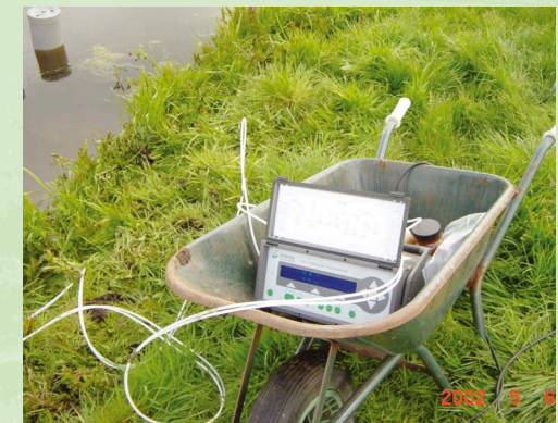
Figuur 3. Het meten van stikstof vervluchtiging in een veenweide polder.
