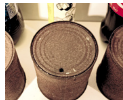
De kruipolie van Kroon slaagde er als enige in wat blanke plekjes te maken op de bodem van het conservenblik.
