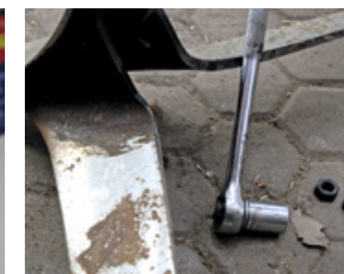
Bij het losdraaien van verroeste moeren maakte WD-40 de beste indruk.
