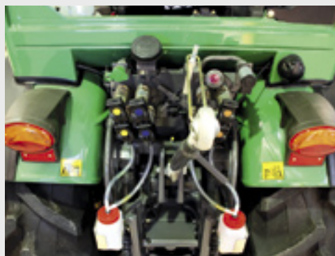
Maximaal zijn er zes dubbelwerkende ventielen aan zowel de achter- als zijkant.
