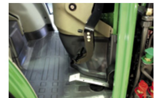
De cabine heeft nu een vlakke vloer. Met de witte gaspedaal kun je ook rijden zonder de joystick te gebruiken.
