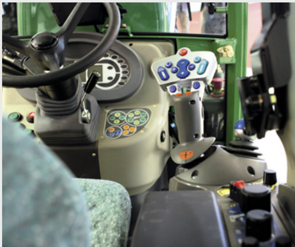
Optioneel is deze multifunctionele joystick waarmee je naast de transmissie ook vier dubbelwerkende ventielen, de hef, aftakas en vooringestelde functies kunt bedienen.
