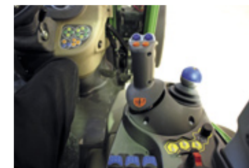
Met de standaardjoystick bedien je de Vario. Versnellen en langzamer rijden is een kwestie van vooruit of achteruit duwen.
