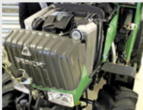
De neus is omgetoverd tot dieseltank, de koelers zitten aan beide zijkanten.
