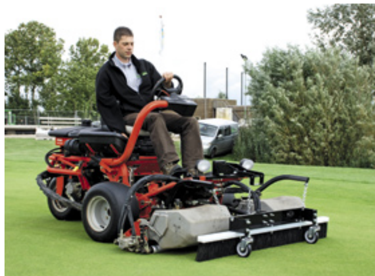
Met een bezem voor de Jacobsen G-Plex greenmaaier is er een nog beter maairesultaat, volgens Verschoor uit Almkerk. Die haalt het gras omhoog.
