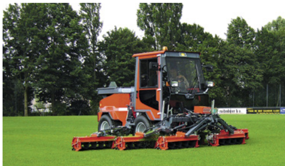
Met de zeventalige Nimos DM-Trac 408 is een grote capaciteit te halen, en je kunt de werktuigdrager buiten het seizoen voor ander werk inzetten.
