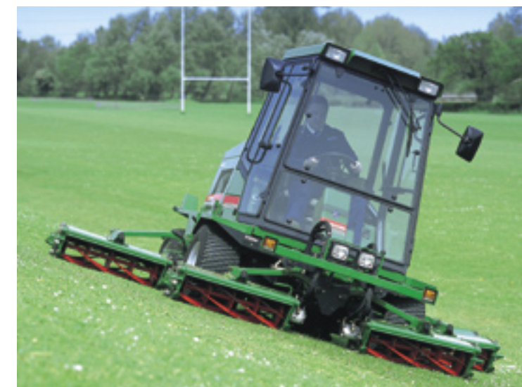
De Ransomes Commander 3520 is ook leverbaar met zesmessige Super Sports units van 91 cm.
