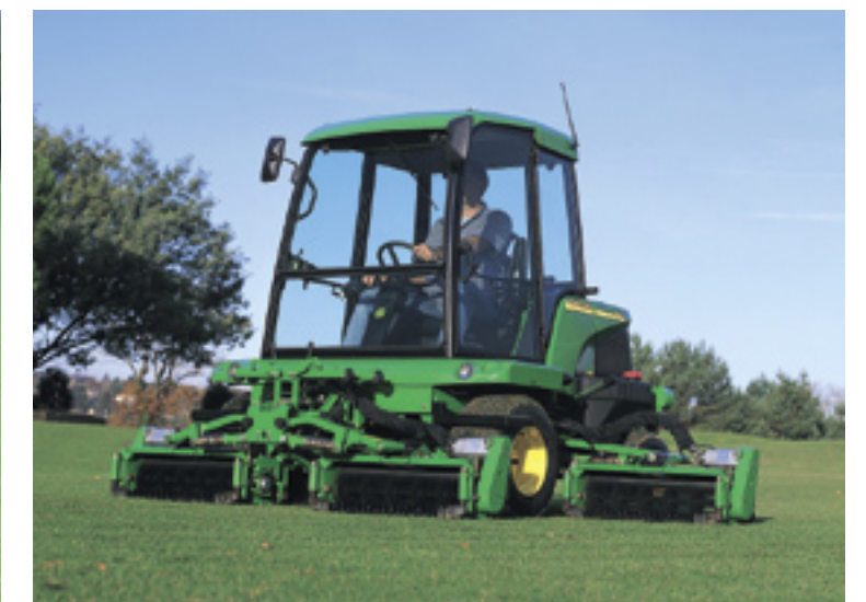
De John Deere 1905 is met 250 mm grote jumbokooien en met 90 cm kooien leverbaar.
