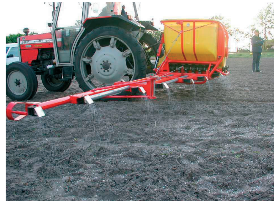
Met de beddenstrooier is het mogelijk gerichter te bemesten: een forse besparing en minder belasting van het milieu.
