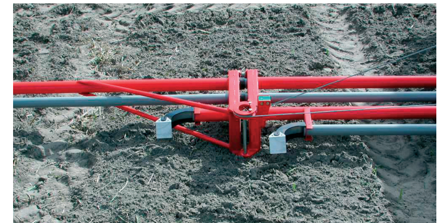
Dicht over het bed komt de korrel zo dicht mogelijk bij het gewas terecht.
