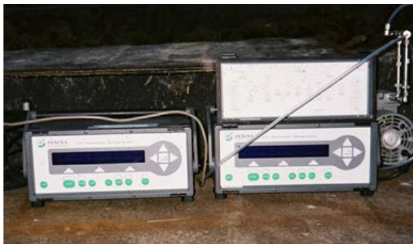
Innova 1312 voor het meten van de stal- en achtergrondconcentraties van \text{NH}_3 en \text{CO}_2 .
