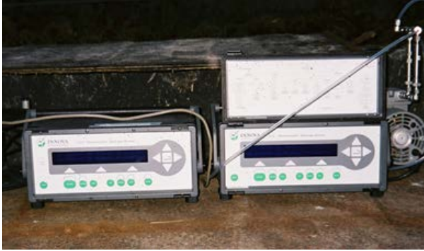
Innova 1312 voor het meten van de stal- en achtergrondconcentraties van \text{NH}_3 en \text{CO}_2 .
