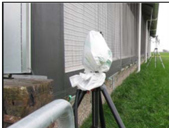
Opstelling laser buiten (de plastic zak over de laser is ter bescherming tegen vocht)
