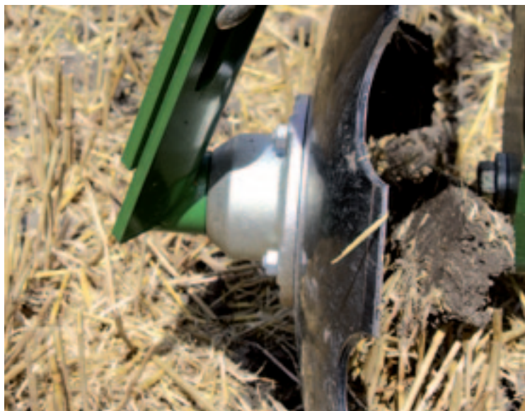
▲ De buitenste schijven zijn apart in diepte instelbaar. Door ze iets ondieper te zetten, houdt je geen richel over.
