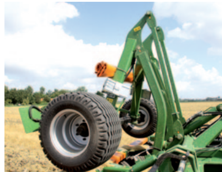
▲ Het transportstel is optioneel. Bij een bandenrol dient deze als onderstel. Met de doeken scherm je de onderste schijven af bij wegtransport.
