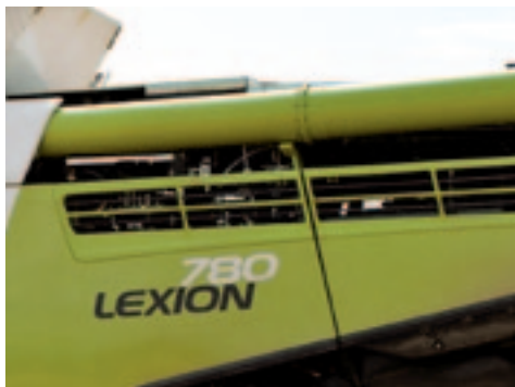
▲ Door de ‘kieuwen’ in het plaatwerk blijft het stof laag en vervuilt het de combine niet.
