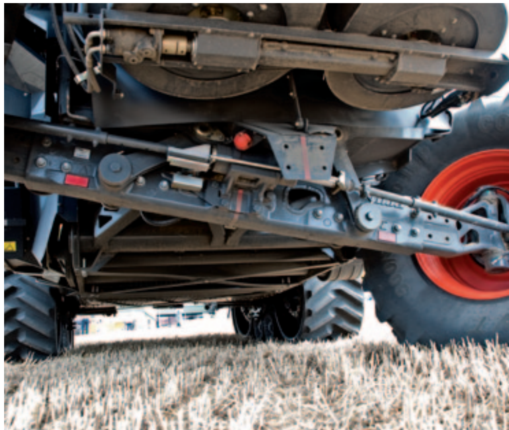
▲ De achteras uit eigen huis werkt tweedimensionaal. Door de vier bewegende punten en schuine plaatsing van de stangen, bewegen de wielen zowel horizontaal als verticaal bij het nemen van obstakels.
