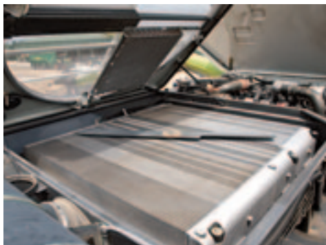
▲ De 770 en 780 hebben een liggend koelpakket. Claas gebruikt de luchtstroom handig.
